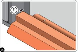
LOCATE DOOR STRIP 0205-11 OR 0205-73 AS SHOWN. IMPORTANT: ENSURE DOOR STRIP IS PUSHED AGAINST DOOR POST RETURN.
