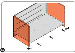
NOTE: SLIGHT OUTWARD ADJUSTMENT OF SIDE PANELS MAYBE REQUIRED. LOCATE FLOOR PANEL AND CAREFULLY POSITION BETWEEN SIDE PANELS.
