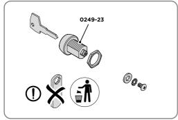
LOCATE AND DISASSEMBLE CAM LOCK ASSEMBLY 0249-23. AS SHOWN ABOVE.
