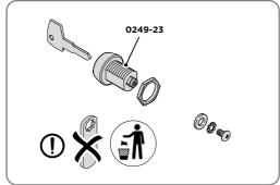
LOCATION AND DISASSEMBLE CAM LOCK ASSEMBLY 0249-23. AS SHOWN ABOVE.
