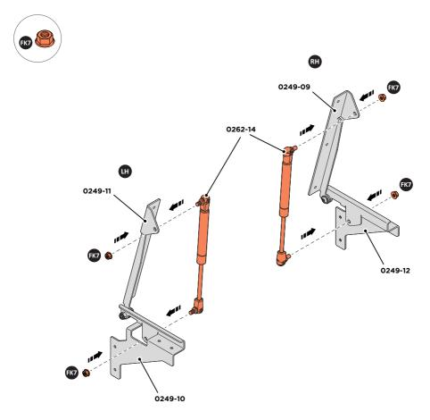
ROTATE BOX FRAME TO IT'S UPRIGHT POSITION. SECURE GAS STRUT & LID HINGE ASSEMBLIES TO PANELS & FRAME AS SHOWN.
