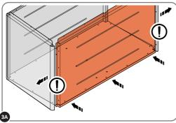
NOTE: SLIGHT OUTWARD ADJUSTMENT OF SIDE PANELS REQUIRED. LOCATE FRONT PANEL AND CAREFULLY POSITION BETWEEN SIDE PANELS. THE BOTTOM FRONT PANEL SLIDES UNDERNEATH FLOOR PANEL.
