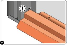
LOCATE DOOR STRIP 0204-07 OR 0204-70 AS SHOWN. IMPORTANT: ENSURE DOOR STRIP IS PUSHED AGAINST DOOR POST RETURN.
