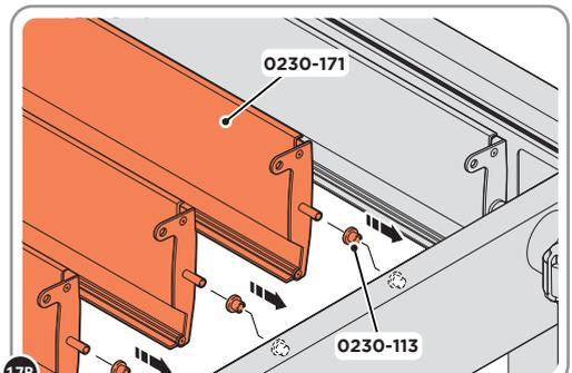
**17B** SECURE LOUVER BEARING 0230-113, LOCATED ON THE GEARBOX SIDE TO BEAM AS SHOWN ABOVE.
