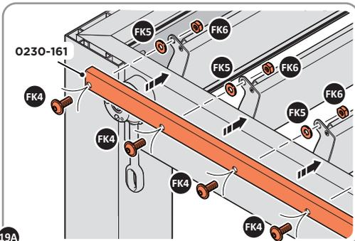
DURING ASSEMBLY ENSURE THE FRICTION WASHERS (FK5) ARE LOCATED BETWEEN THE LINK ARM AND LOUVERS. LEAVE FIXINGS FINGER TIGHT.
