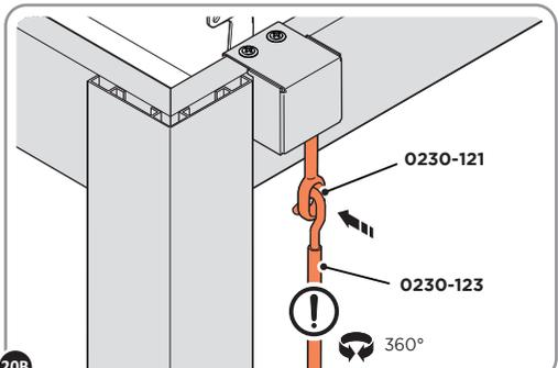
**20B** ATTACH CRANK HANDLE 0230-123 TO GEARBOX 0230-121.
