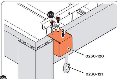
**20A** LOCATE GEARBOX COVER 0230-120 AND SECURE TO TOP OF PERGOLA BEAM USING X2 ECO FIX SCREWS (FK8).
