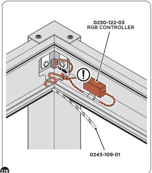
22B POSITION RGB CONTROLLER AND CABLE INSIDE BEAM AS SHOWN ABOVE.
