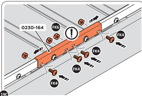
**NOTE:** SECURE LINK ARM CONNECTORS WITH FIXINGS FK4 & FK6 AND FULLY TIGHTEN.
