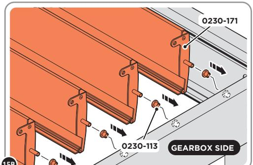
15B SECURE LOUVER BEARING 0230-113, LOCATED ON THE GEARBOX SIDE TO BEAM AS SHOWN ABOVE.
