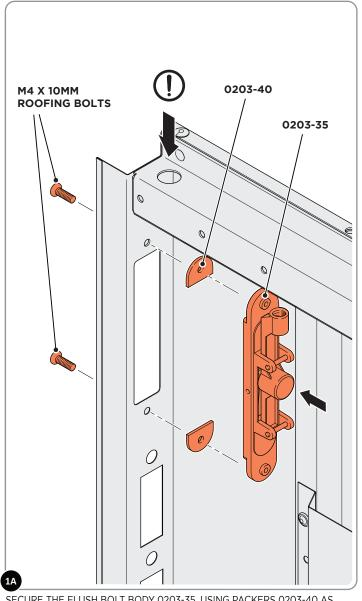
SECURE THE FLUSH BOLT BODY 0203-35, USING PACKERS 0203-40 AS SHOWN ABOVE, ENSURE THE THREADED BOSS IS FACING THE HOLE IN THE DOOR.
